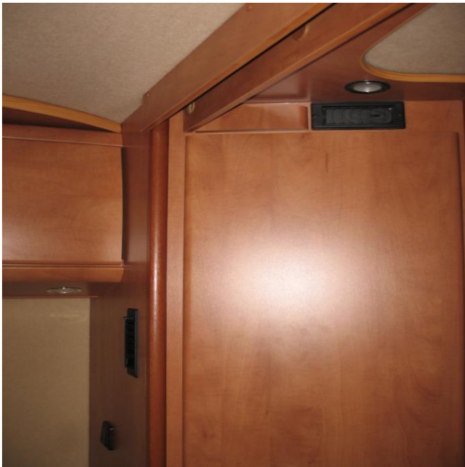
zusätzl. Ausblasdüsen Klimaanlage
